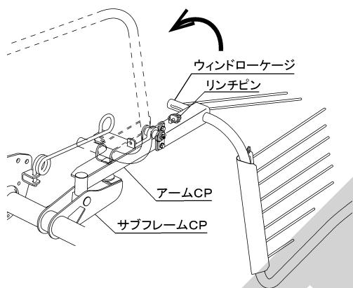
2. トラクタ座上より、ストッパパイプを押し下げ回し、ストッパプラケットを運搬状態の穴位置に入れます。
