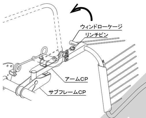
2. トラクタ座上より、ストップパイプを押し下げ回し、ストップブラケットを運搬状態の穴位置に入れます。
