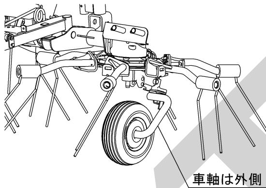
(4) サブフレームCP; L (R) にアームCP; L (R) をデルタピンにて取付けます。
